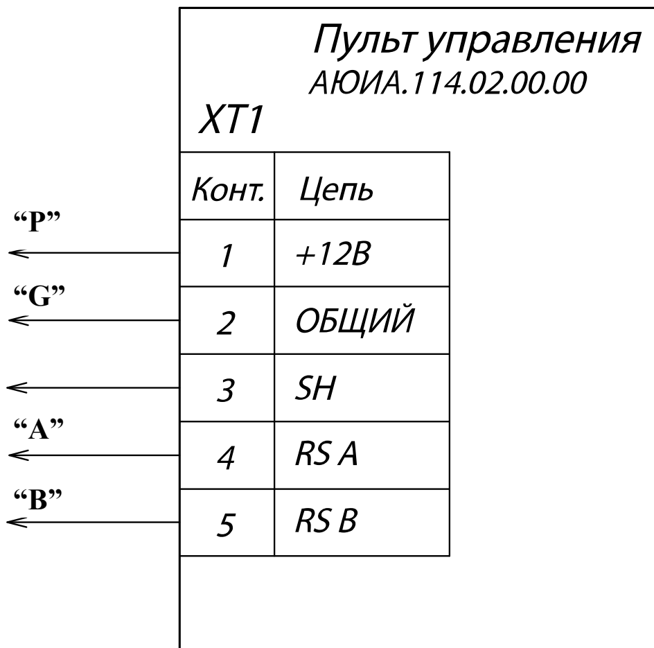
Рис. Б.2 – Схема электрическая подключения пульта управления АЮИА.114.02.00.00
