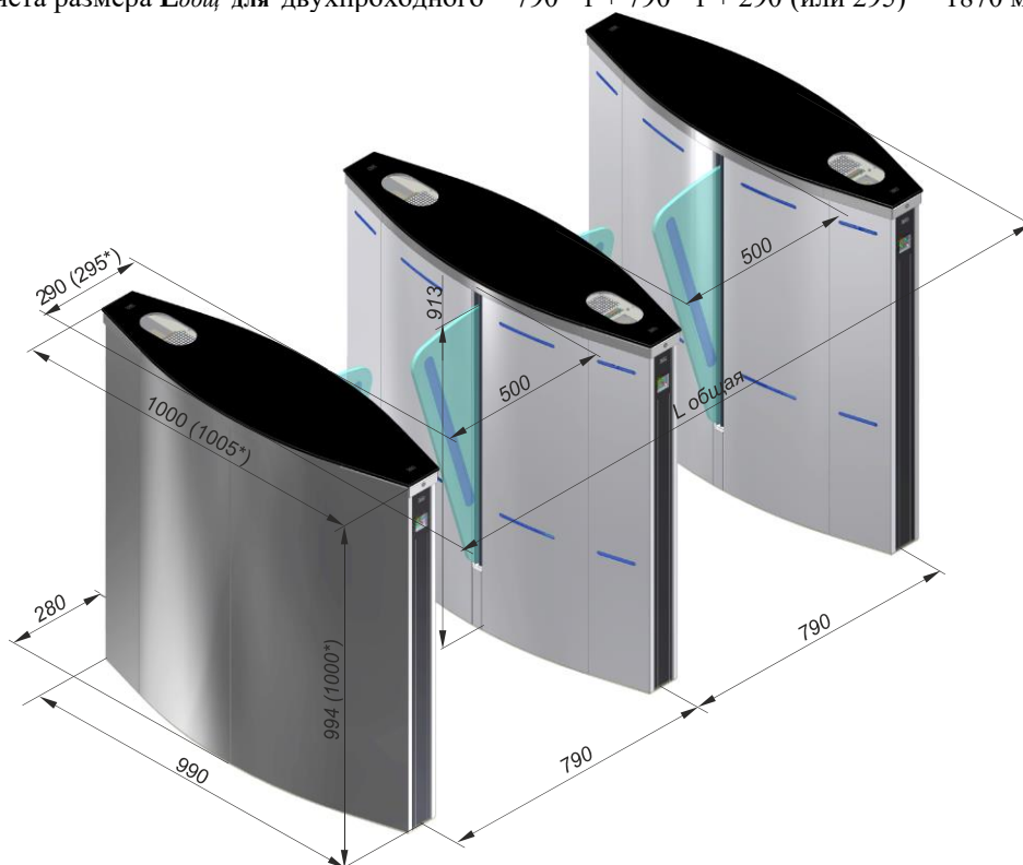
Рис. 2 – Габаритные размеры группы турникетов
