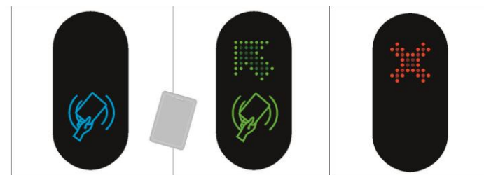
Рис. 6 - Отображения статуса турникета на индикации
