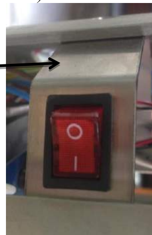
б) кнопка вкл/выкл питания 220 V
