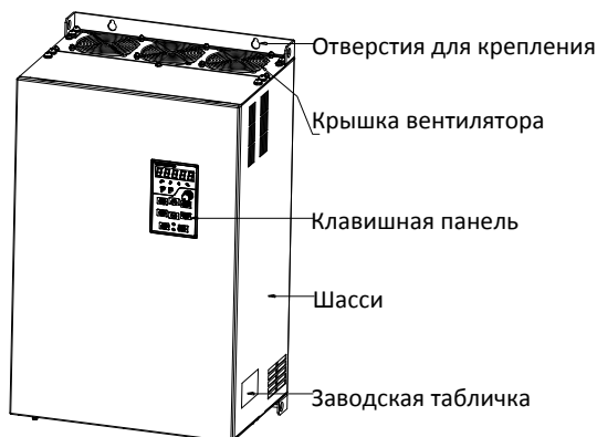
Рис. 2-4 Пример компоновки 18.5 ~ 132 кВт
