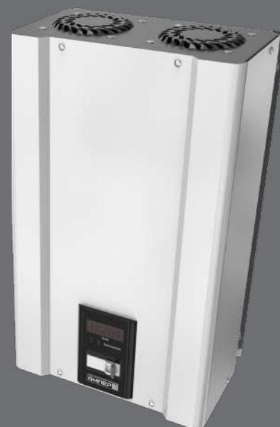
Однофазный стабилизатор напряжения Ампер 9 предназначен для работы в электрических сетях с колебаниями напряжения от 160 до 260В. В этом диапазоне аппарат выдает на выходе напряжение в рамках  $220V \pm 4.5\%$ , что обеспечивается за счет использования 9 ступеней стабилизации.
