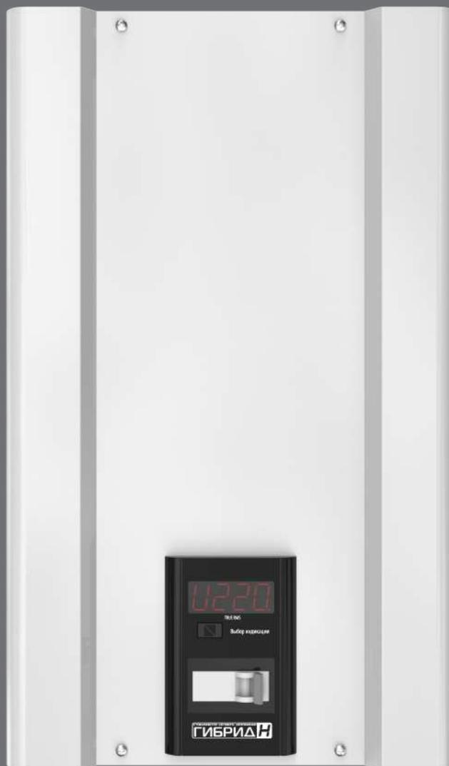
Устанавливать и эксплуатировать стабилизатор Гибрид рекомендуется в сухих и отапливаемых помещениях. Настенную установку рекомендуется производить в вертикальном положении (вентиляторами вверх), оставив сверху и снизу 10-15 см для охлаждения. Подключение осуществляется к существующей проводке через клеммную колодку для аппаратов от 5.5 до 18кВт и через встроенный шнур с вилкой и розеткой на корпусе стабилизатора для моделей 2.2 и 3.5кВт.
