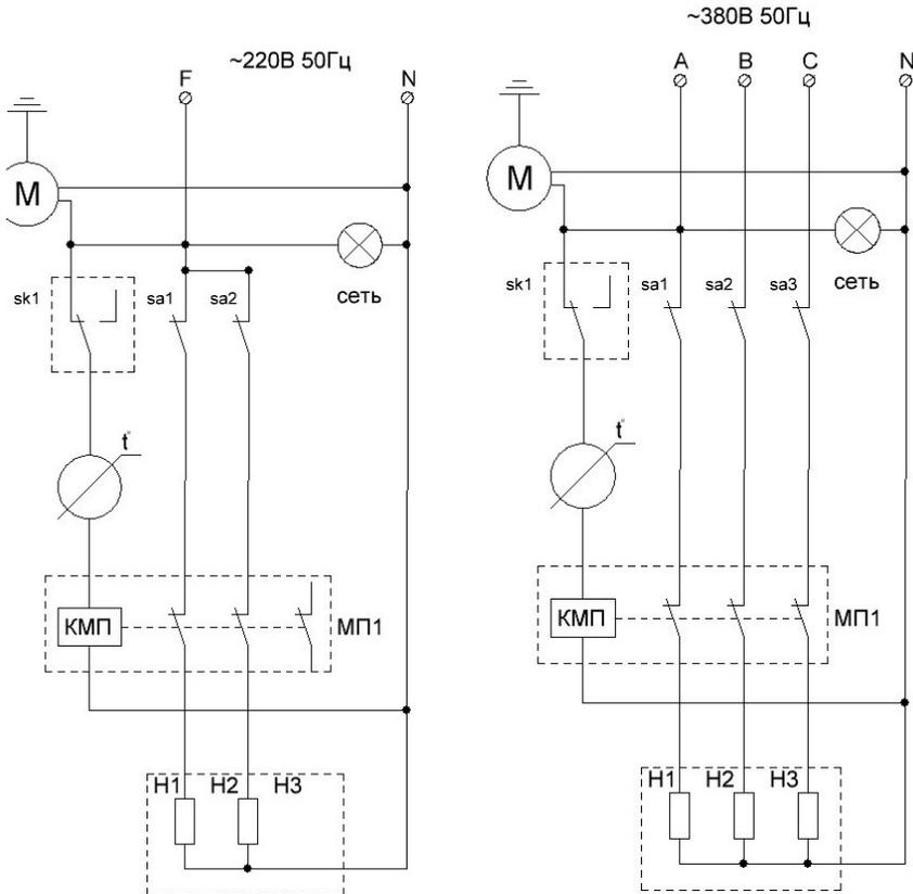
МП 1 – пускач електромагнітний; КМП1 – котушка пускача; Н1..Н3 – ТЕН; SK1 – контакт терморегулятора; SA1..SA3 – автоматичні вимикачі , М1- циркуляційна помпа, Т1- термо-запобіжник.
