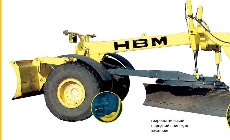
Грейдер BG 240 относится к числу самых мощных в мире. Гидродинамический тандемный привод передает особенно в начале движения очень сильный вращающий момент на 4 задних колеса и гарантирует отличное ускорение даже под полной нагрузкой. В сочетании с гидростатическим приводом на переднюю ось (опция) могут выполняться без заминки даже самые тяжелые работы. При работах на сложных грунтах путем последовательного подключения блокировок
