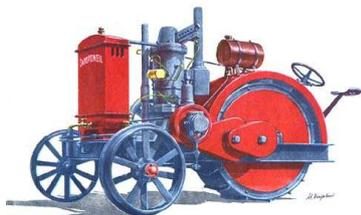
Одна из самых известных моделей старых советских тракторов – «Запорожец». Он был сконструирован инженером Л. А. Унгером на небольших госзаводах №14 и №11. Трактор был укомплектован двухтактным одноцилиндровым нефтяным двигателем «Триумф» мощностью 12 л. с. Эти типы двигателей производились на большетокмакском госзаводе №8.
