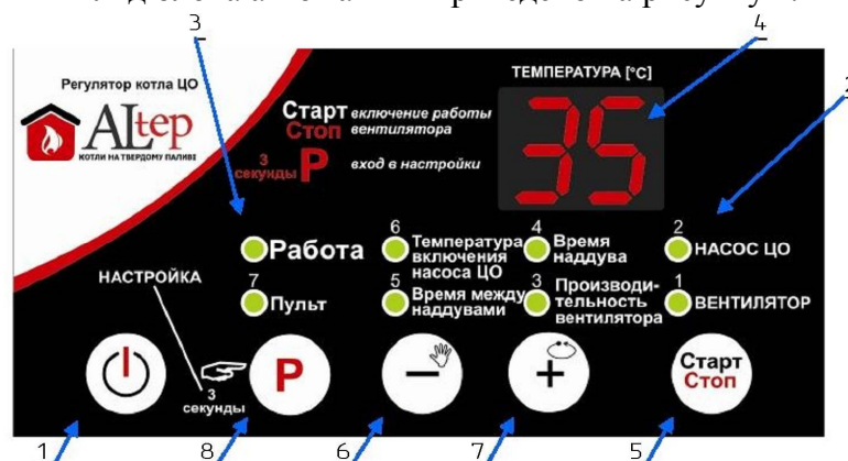
Рисунок 4 – Зовнішній вигляд передньої панелі контролера
