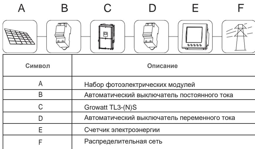
Growatt TL3-(N)S принимает ток от PV модулей и преобразует его в переменный ток для распределительной сети (F). Избыток энергии может привести к тому, что счетчик(E) начнет работать в обратном направлении. Growatt TL3- (N) S подходит для использования как внутри помещений, так и на улице.
