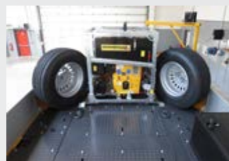
Дизельная силовая установка
