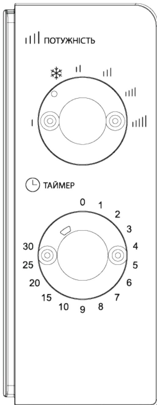
Панель управління має дві функції управління. Одну з них виконує ручка таймера, а другу ручка потужності
