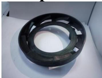
Эта турбина не вращается. Она установлена стационарно, а вода проходя через ее лопасти получает вращательное движение внутри фильтра. Таким образом все тяжелые частицы в воде не попадают в картридж, а оседают на корпус фильтра. Если фильтр установить вниз дренажным отверстием с краном, то периодически можно сливать через кран скопившуюся в корпусе грязь.
