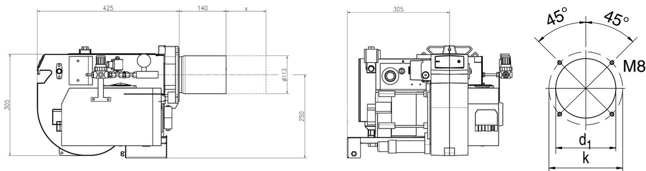
X= Расширение трубки горелки 100 mm и 200 mm
