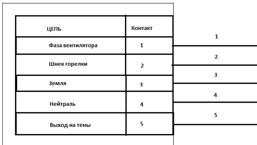
Рисунок 6 – Схема подключения к разъёму GST18I5
