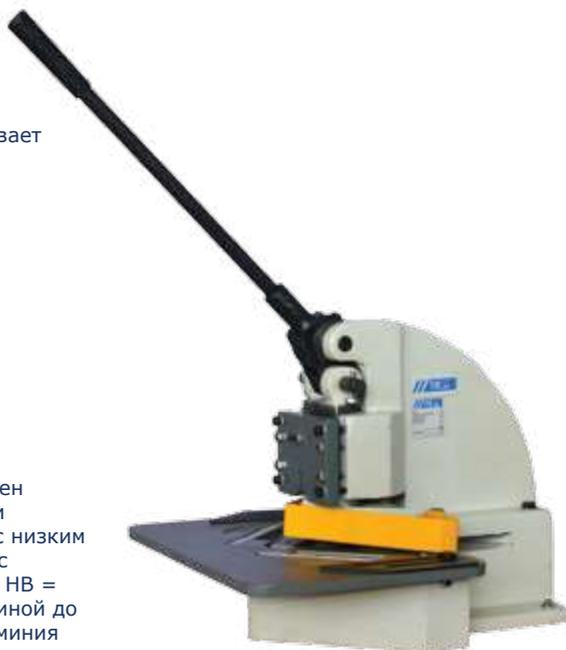
Вырубной пресс HN-4 предназначен для подрезки листового металла и вырубki прямого угла в металле с низким содержанием углерода (типа Ст3 с пределом прочности 500 МПа или HB = 150 единиц по Бринеллю) и толщиной до 1,0 мм, мягкой стали, меди и алюминия толщиной до 1,5 мм.
