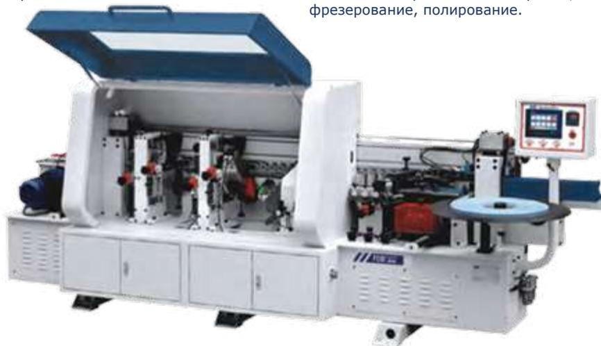
Станок предназначен для облицовывания прямолинейных мебельных плит из волокнистых (ДВП), стружечных (ДСП) материалов и из натурального дерева с нанесением клея на торец мебельной плиты и с последующей подрезкой (фрезерованием) выступающей кромкооблицовочной ленты и полированием срезов с обеих сторон заготовки.
