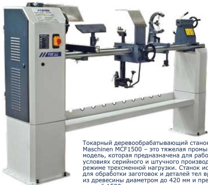
Токарный деревообрабатывающий станок FDB Maschinen MCF1500 – это тяжелая промышленная модель, которая предназначена для работы в условиях серийного и штучного производства в режиме трехсменной нагрузки. Станок используется для обработки заготовок и деталей тел вращения из древесины диаметром до 420 мм и предельной длиной 1500 мм.
