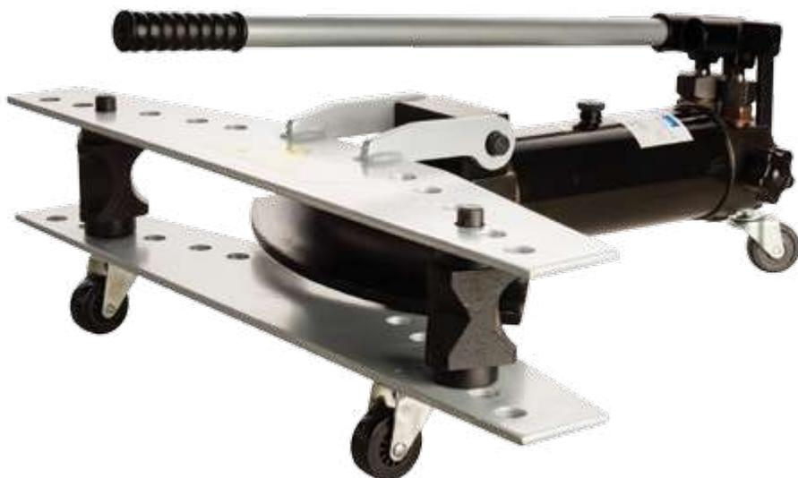
Модель НВМ-240/16-R предназначена для гибки труб. Станок трубогибочный НВМ-240/16-R имеет достаточно простую конструкцию, что повышает его надежность и продлевает срок службы.
