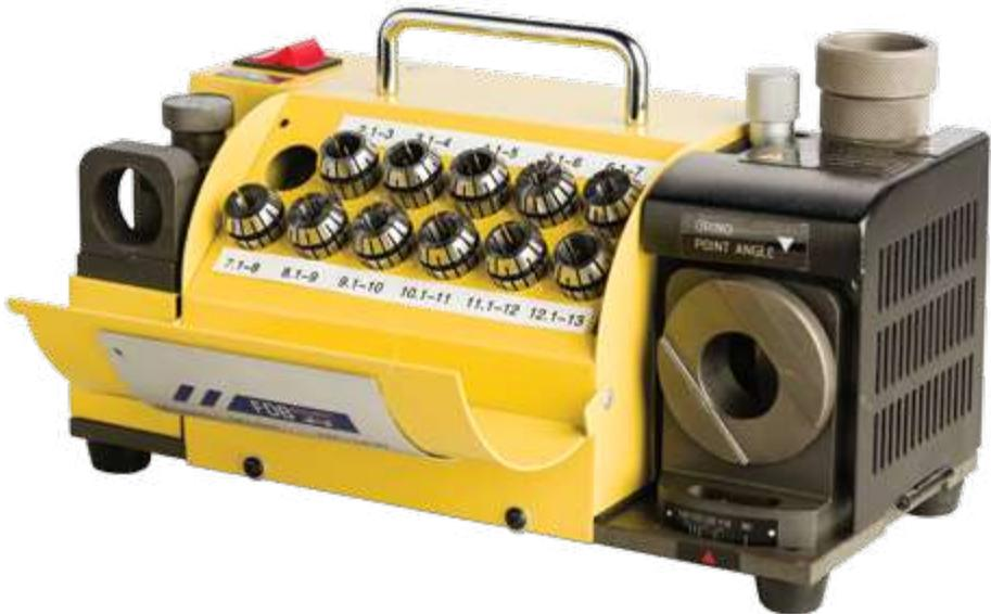
Станок MF13AW предназначен для затачивания передней поверхности режущей кромки сверла, заднего угла и перемычки с возможностью контроля угла заточки.
