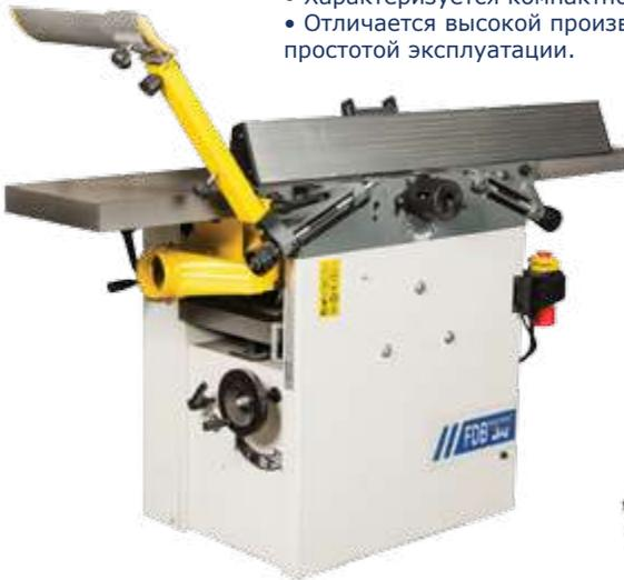
Фуговально-рейсмусовый станок FDB Maschinen MLC 310 предназначен для выполнения строгальных, фуговальных и калибровочных работ с ручной или механической подачей по плоскости и под углом до 45°, для предварительной и окончательной обработки поверхностей заготовки.
