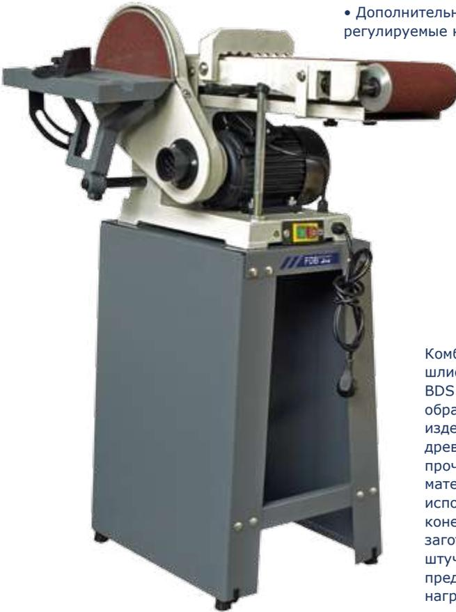
Комбинированный шлифовальный станок BDS 6 предназначен для обработки различных изделий и деталей из древесины, пластика и прочих неметаллических материалов. Станок используется для конечной обработки заготовок в условиях штучного производства на предприятиях с невысокой нагрузкой.
