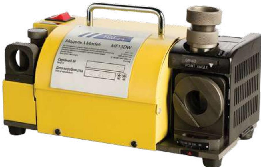
Станок MF13DW предназначен для затачивания передней поверхности режущей кромки сверла, заднего угла и перемычки с возможностью контроля угла заточки.
