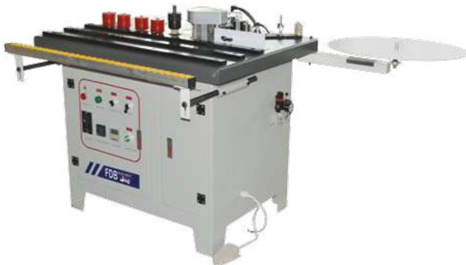
Кромкооблицовочный станок MB50 предназначен для облицовывания прямолинейных и криволинейных кромок мебельных щитов и заготовок натуральным полосовым и синтетическим рулонным материалом толщиной до 5 мм.
