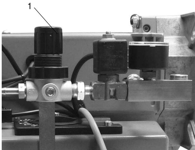
Первичный воздух устанавливается в зависимости от необходимой мощности регулятором давления воздуха (1). Необходимые данные можно определить по ниже приведённой графике. Топливо с большей вязкостью требует более высокое давление воздуха.
