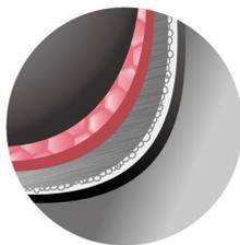
Утолщенная внутренняя чаша 2 мм равномерно распределяет тепло, чтобы блюда получались еще вкуснее
