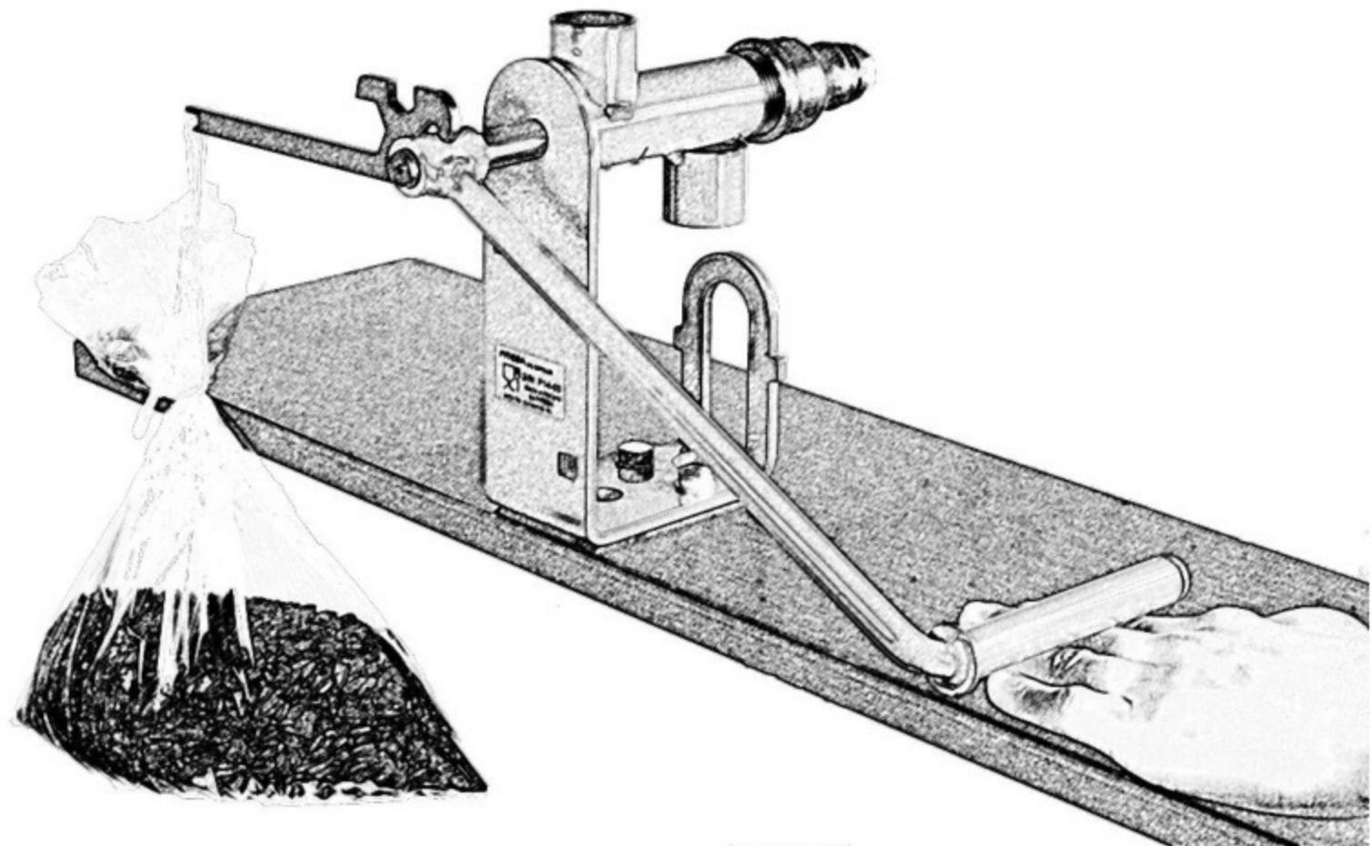
4. Наполните пластиковый пакет и повесьте его на приспособление Piteba: при правильно подобранным весе рукоятка оторвется от стола (между рукояткой и столом должны помещаться пальцы руки). Винтовая ось выполняет роль центра вращения.
