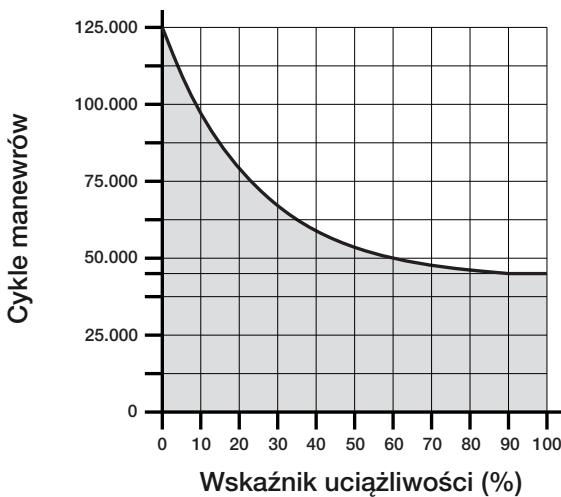
Przykład obliczania trwałości motoreduktora TWingo WG5024 (Odnieść się do Tabeli 2 i do schematu A):
