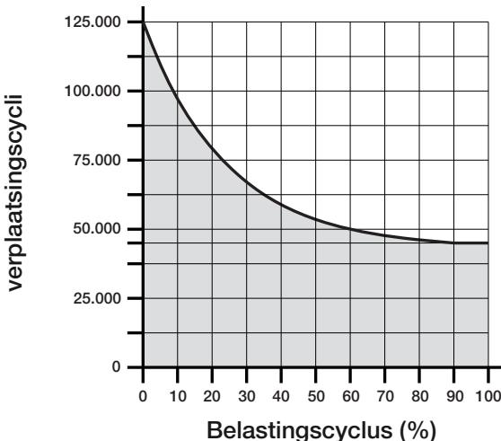
Voorbeeld van een berekening voor de duurzaamheid van een reductiemotor Wingo WG5024 (raadpleeg de Tabel 2 en de Grafiek A):
