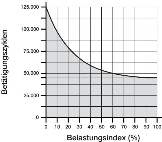
Beispiel für die Berechnung der Beständigkeit eines Antriebs Wingo WG5024 (auf Tabelle 2 und Schaubild A Bezug nehmen):
