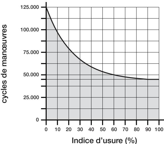
*Exemple du calcul de durabilité d'un motoréducteur Wingo WG5024 (voir Tableau 2 et Graphique A):*
