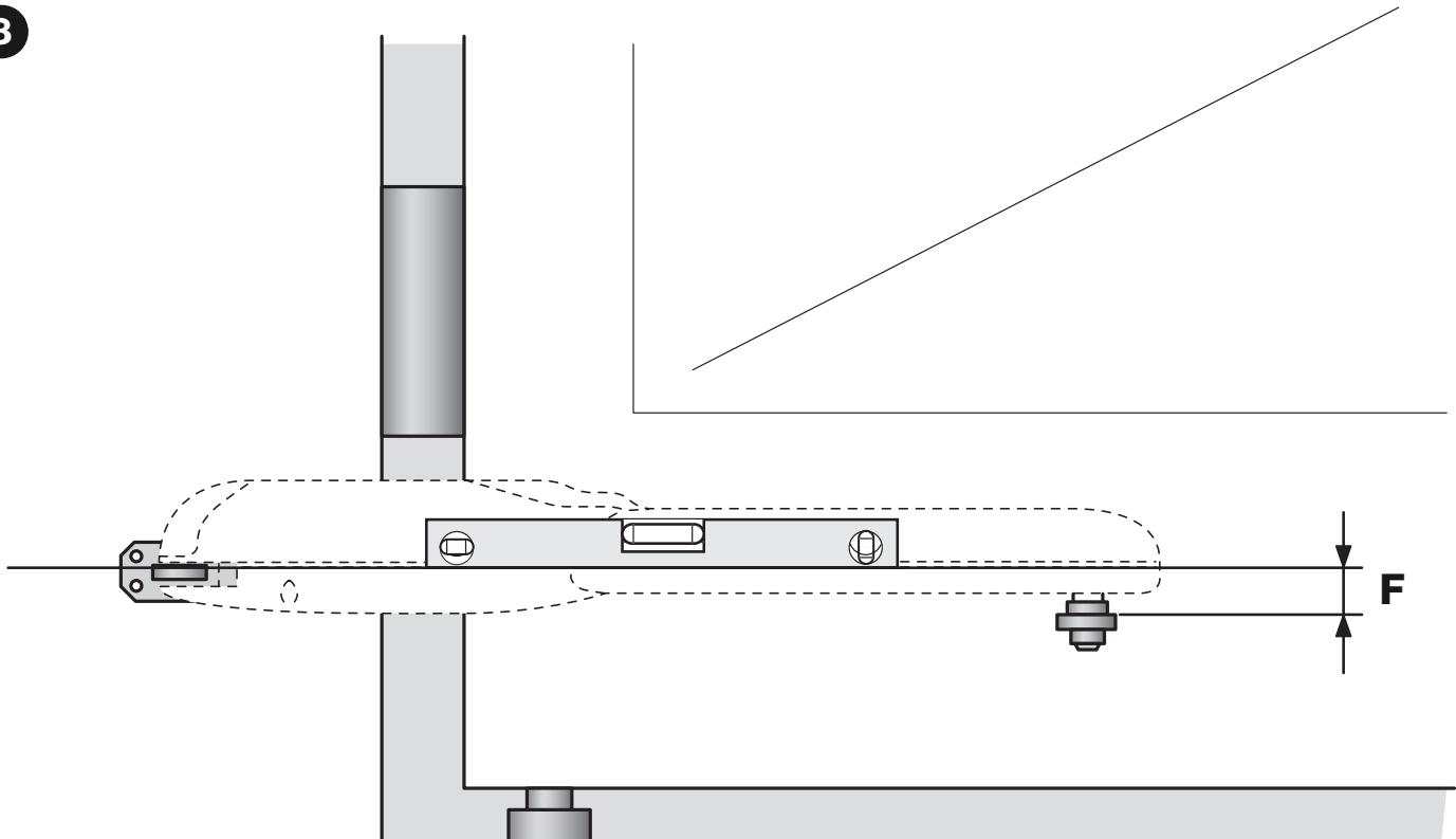
**WG4025 - WG4000 - WG4000/V1:  $F = 30 \text{ mm}$**
