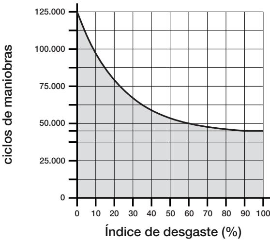
Ejemplo de cálculo de duración de un motorreductor Wingo WG5024 (consulte la Tabla 2 y el Gráfico A):
