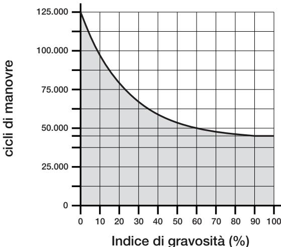
Esempio del calcolo di durabilità di un motoriduttore Wingo WG5024 (fare riferimento alla Tabella 2 e al Grafico A):
