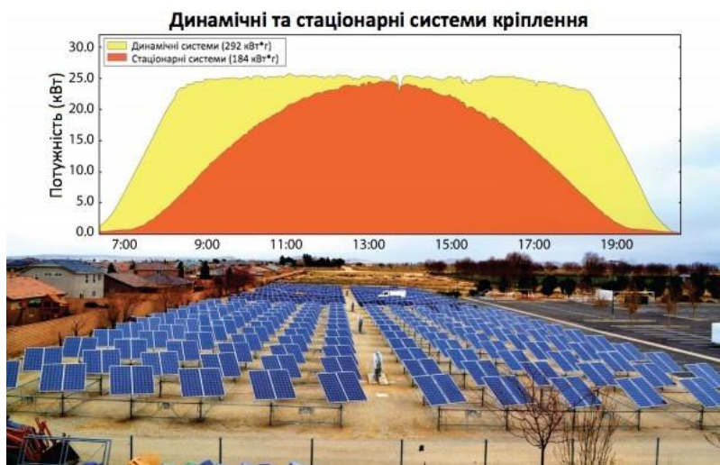
Мал. 1. Порівняння продуктивності СЕС 30 кВт DC при вирощанні рухомих та стаціонарних систем кріплення в розрізі доби (світлої частини).
