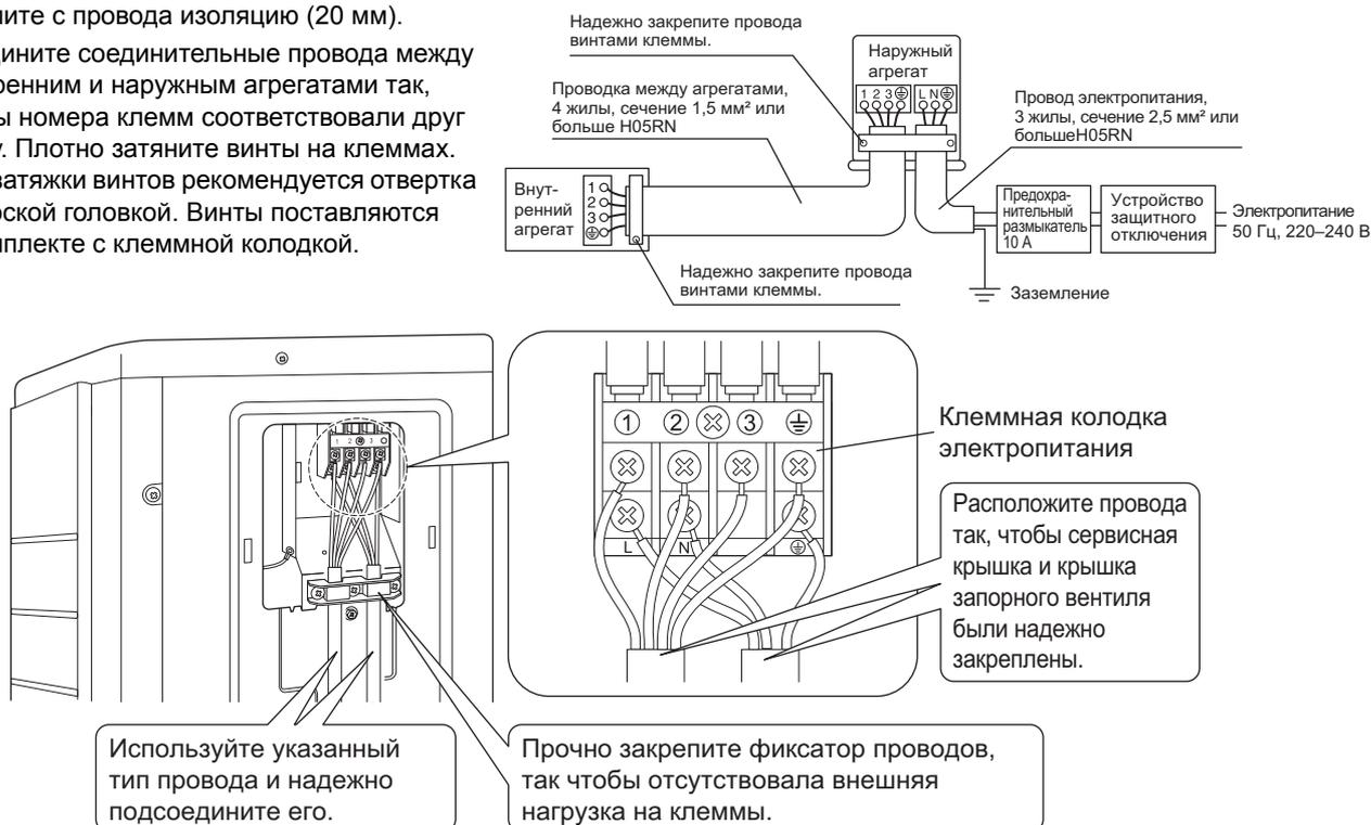
При подключении проводов к клеммной колодке источника питания обращайте внимание на приведенные ниже замечания. Меры предосторожности в отношении проводки источника питания.
