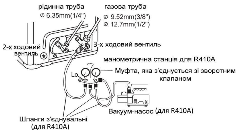
Схема приєднання вакуум-насосу до зовнішнього блоку
