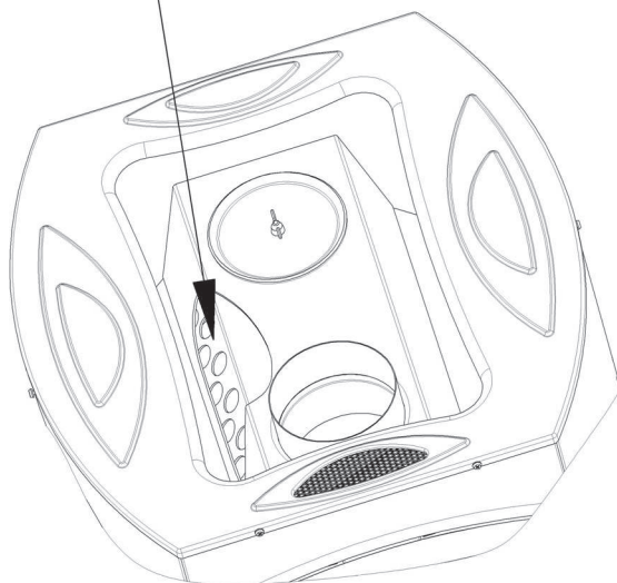
Рисунок 5 Конструкция рассекателя пламени
