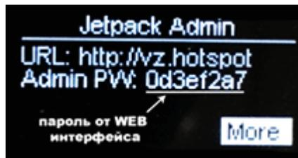
При нажатии кнопки "ОК/меню" отобразится адрес, который необходимо набрать в адресной строке браузера для того, чтобы попасть на WEB-интерфейс устройства и пароль от него. Как правило, это адрес: <http://vz.hotspot> или <http://192.168.1.1>. Пароль у каждого устройства индивидуальный.
