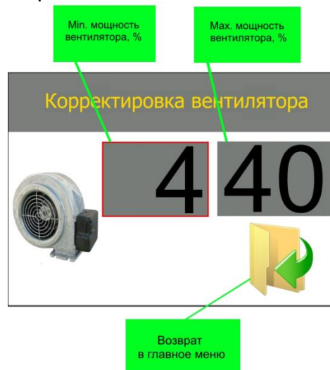
Рисунок 23 – Окно изменения мощности вентилятора (розжиг)
