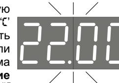
❷ Блокировка кнопок (защита от детей и т.п.). Включите обогреватель в электрическую розетку при зажатой кнопке '+' и не отпускайте ее до появления соответствующей индикации и звукового подтверждения.
