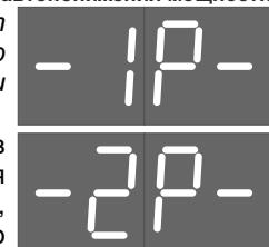
Если у Вас не хватает мощности электросети (выбивает защитный автомат), Вы можете включить функцию автоматического понижения мощности обогревателя (на 50%) при достижении заданной температуры.
