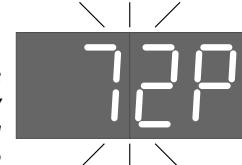
Для установки предельной температуры нажмите любую кнопку. Отобразится и начнет мигать установленное значение температуры воздуха в помещении 'C'. Пока значение мигает одновременно нажмите и удержите обе кнопки не менее 2-х секунд. После звукового сигнала отобразится и начнет мигать установленное значение предельной температуры поверхности обогревателя 'P'. Установите новое значение и подождите 6 секунд для выхода из режима установок.
