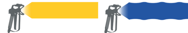
Рис.: При низком давлении: равномерная струя распыления от диафрагменного насоса (желтая) и неравномерная струя распыления от поршневого насоса (синяя).
