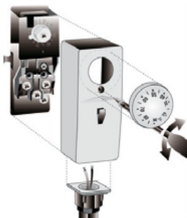
Rys. 3: Demontaż obudowy termostatu
