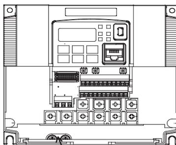
Заземление на шасси (M4)
