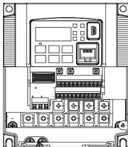
Заземление на шасси (M4)
