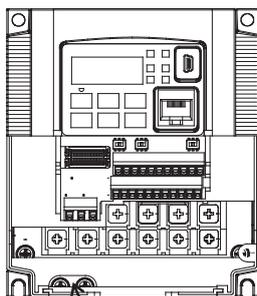
Заземление на шасси (M4)
