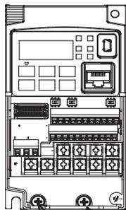
Заземление на шасси (M4)
