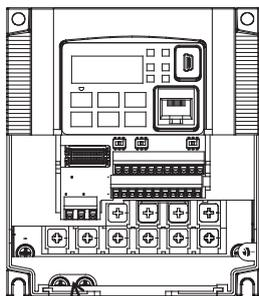
Заземление на шасси (M4)
