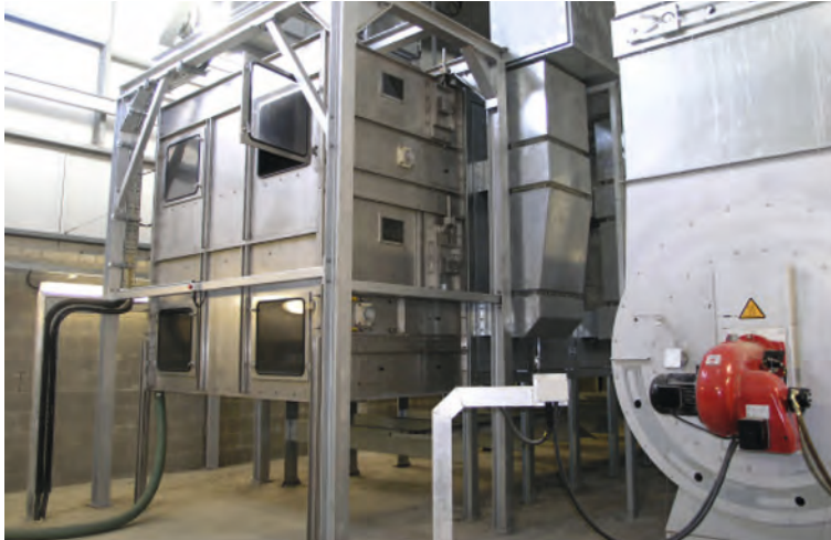
Проект: Wexford Ирландия Тип: РВТ 2/2500-12 Продукт: осадки сточных вод Производительность испарения воды: 1.250 кг/ч
