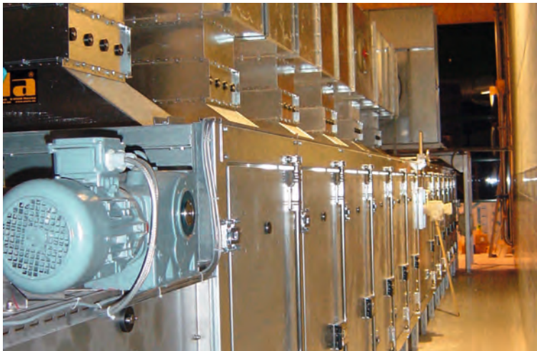
Проект: ARA Sölden Австрия Тип: РВТ 1/2500-13 Продукт: осадки сточных вод Производительность испарения воды: 800 кг/ч
