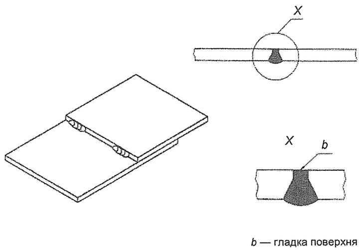
Рисунок В.5 — Зварні з'єднання
