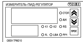
Рисунок 6.2 – Лицевая панель прибора для корпусов: 1) настенного Н и щитового Щ1 крепления, 2) щитового Щ2, 3) настенного Н2
