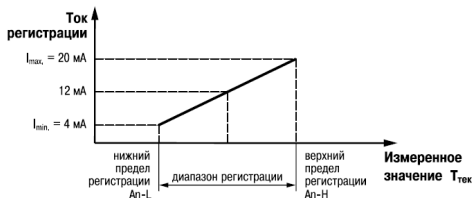
Рисунок 7.6 – Настройка диапазона в случае A_n.L < A_n.H
