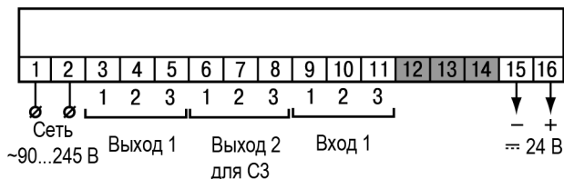
Рисунок 5.2 – Назначение контактов клеммной колодки прибора в настенном Н и щитовом Щ1, Щ2 типах корпусов
