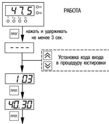
Рисунок 8.4 – Последовательность работы при юстировке
