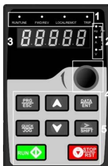
Рис. 5-1 Внешний вид панели управления
