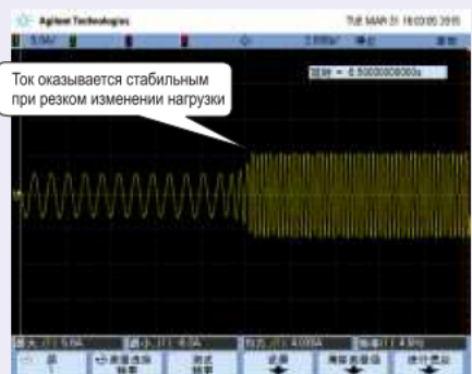
Форма тока при внезапной нагрузке в режиме векторного управления с полной нагрузкой на частоте 0,5 Гц.
