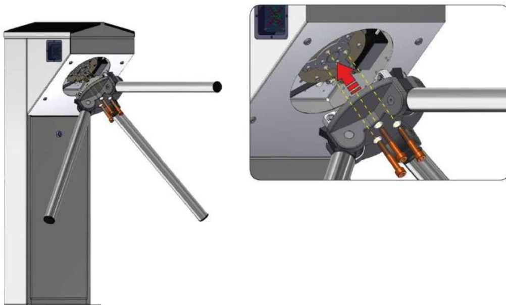
Рис. 14 – Установка ступицы с поводками в корпус турникета-трипода
