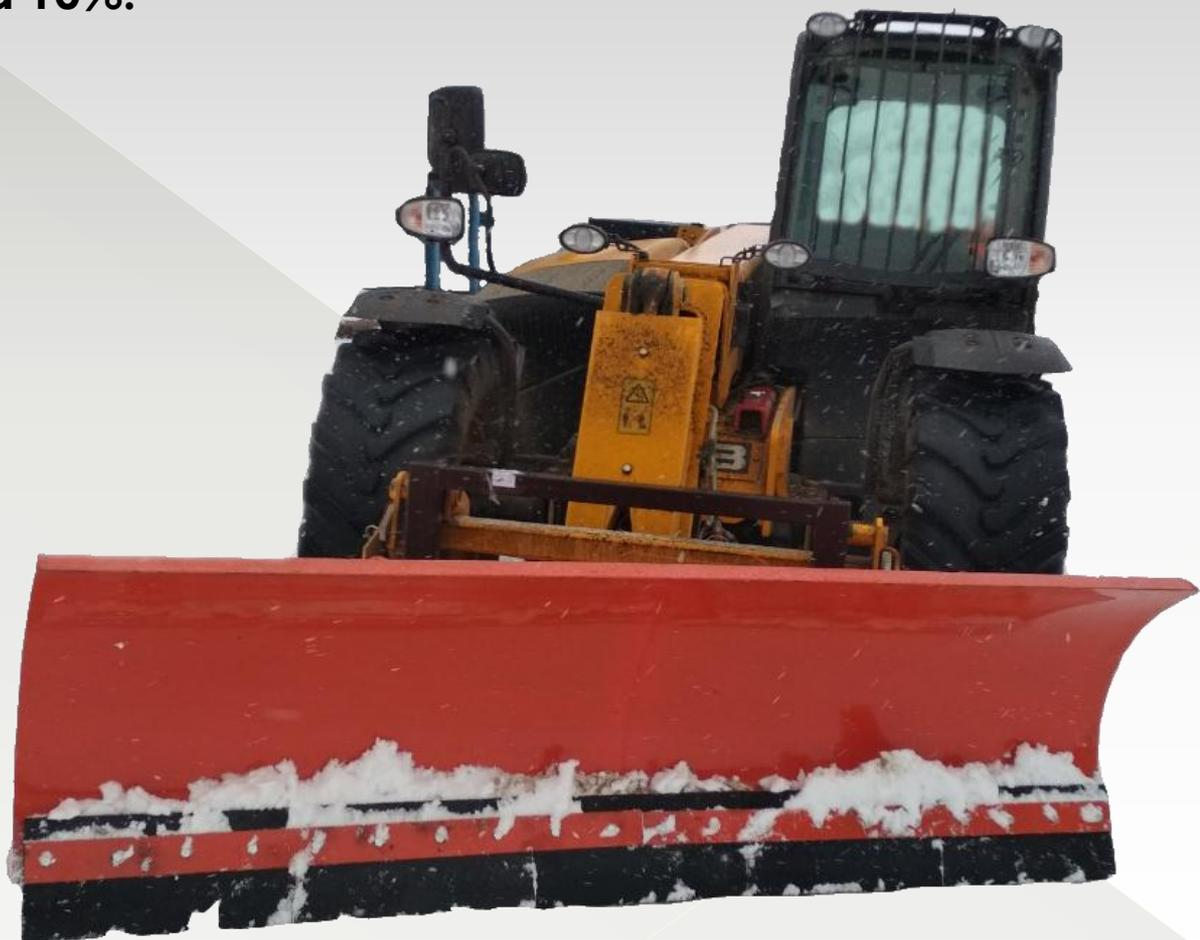
Отвал для снега для мини-погрузчиков Bobcat, Caterpillar, Volvo, Komatsu, JCB, Case, Doosan, Avant, Hyundai, New Holland и др.
