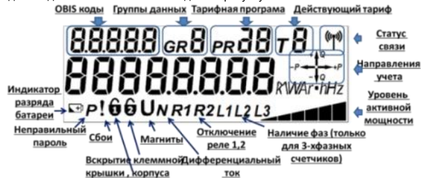
Рисунок 2 - Загальний вигляд дисплея лічильника
