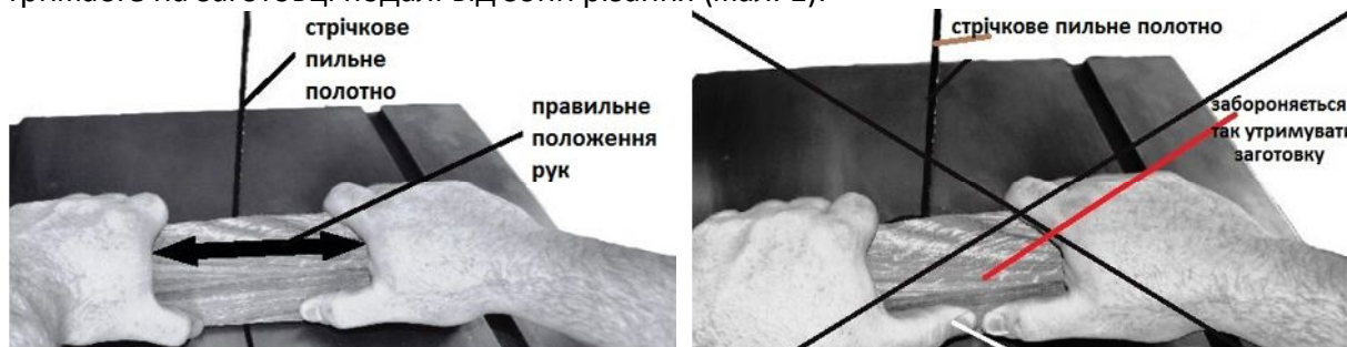
Мал. 1 Схема розпилювання заготовки
