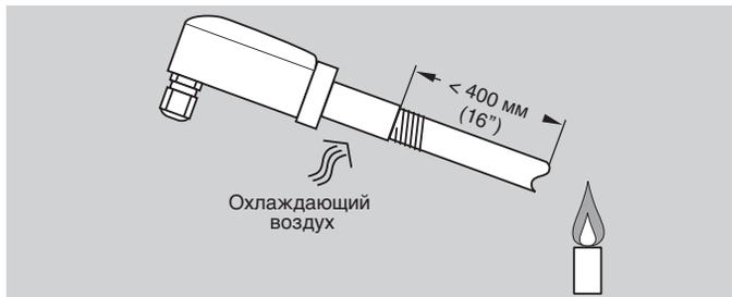
Установка с помощью 1/2" смотровой трубки, которая должна быть направлена на верхнюю треть факела, поскольку обычно в этой области самое высокое УФ излучение. Внутренняя поверхность стальной трубки должна быть гладкой. Трубка направляется на пламя сверху так, чтобы перед УФ-датчиком не было никаких помех.
