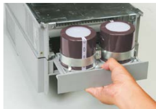
Легко-снимаемые конденсаторы шины постоянного тока (SJ700B: свыше 18,5 кВт)
