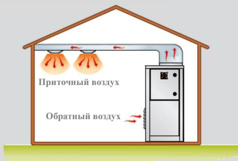
В данных вариантах исполнения воздух, выходящий из установки, всегда теплее входящего воздуха. Тепловая энергия, образуемая установкой, зависит от термально-гидрометрических условий окружающей среды.
