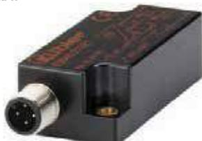
**Вимірюваний діапазон:**  $\pm 10^\circ$ ,  $\pm 45^\circ$ ,  $\pm 60^\circ$ . **Кількість осей:** 2. **Діапазон:**  $\leq 0.05^\circ$ ,  $\leq 0.1^\circ$ ,  $\leq 0.15^\circ$ . **Час реакції:** 0.1...0.5 с. **Тип виходу:** CANopen, аналоговий (4...20 mA, 0.1...4.9 V). **Напруга живлення:** 5 VDC, 10...30 VDC. **Особливості:** вібростійкість, захист від зміни полярності, коректировка нуля  $\pm 5^\circ$ , швидкий монтаж та підключення.
