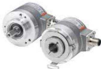
**Діаметр корпусу:** от 24 мм до 90 мм. **Діапазон:** ST 9...17 Bit, MT 29 Bit (17x12 Bit). **Напруга живлення:** 5...30 VDC. **Код:** Грей, бінарний. **Інтерфейс:** SSI, SSI+інкрементальний, SSI+Sin/Cos, BiSS, RS485, BiSS+інкрементальний, BiSS+Sin/Cos, Parallel, AWG-Pr., аналоговий (4...20mA, 0...10V), CANopen, Profibus, ProfiNET, ...
