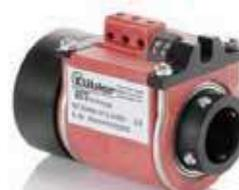
**Діаметр корпусу:** 60 или 85 мм. **Порожнистий вал:** 18...25 або 20...30 мм, 1". **Макс. швидкість:** 500 об./хв. **Силкові кільця:** 240 V AC/DC, 16 A або 400 V AC/DC, 20 A. **Сигнальні кільця:** 48 V AC/DC, 2 A. **Кількість кілець:** 20. **Спеціальні версії:** пневматика, гідравліка. **Особливості:** просте підключення, вібростійкість, сигнали промислових мереж (Profibus, CANopen, ...).
