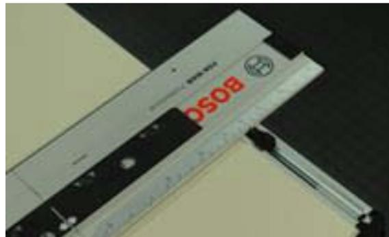
Угловой упор позволяет зафиксировать направляющую под прямым или нужным углом
