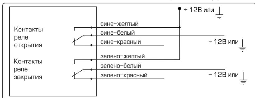
Схема подключения к двухпроводным электроприводам управления
