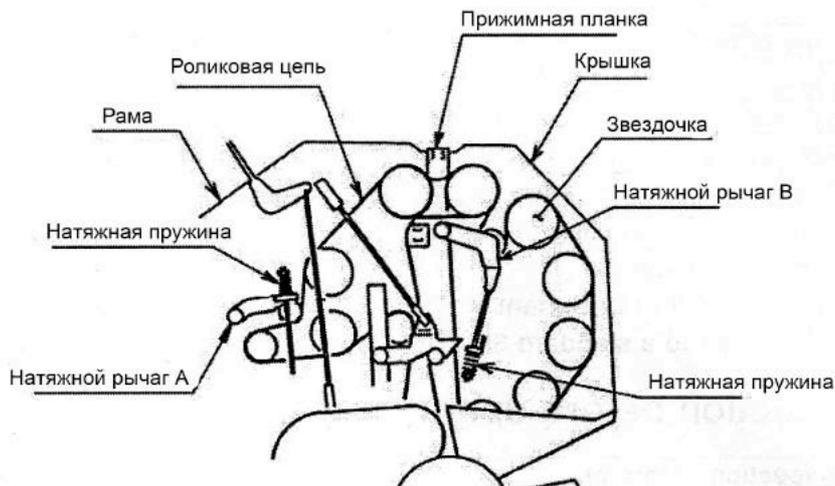
1.1.9. Натяжные пружины обеспечивают правильное натяжение роликовых цепей
