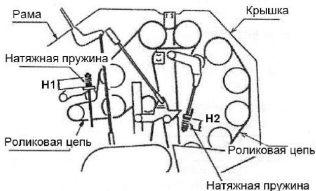
13.2.1. Регулировка натяжного ролика цепи. Отрегулируйте натяжной ролик для нормальной работы цепи. Поскольку роликовая цепь особенно удлиняется при первом использовании, проверьте регулировку после первого дня работы.
