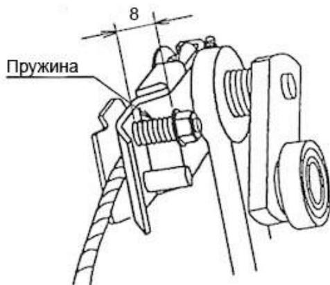
13.3.7 Регулировка натяжения шпагата на рычаге обмотчика.
