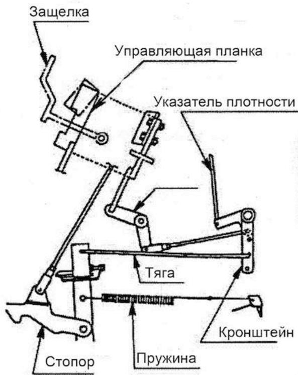
1.1.10. Тяга и кронштейн служат для регулировки плотности рулонов путем изменения положения тяги в отверстиях кронштейна
