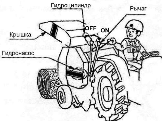
1.1.13. Гидронасос, гидроцилиндр и рычаг предназначены, чтобы открывать и закрывать крышку камеры прессования для выбрасывания рулонов.
