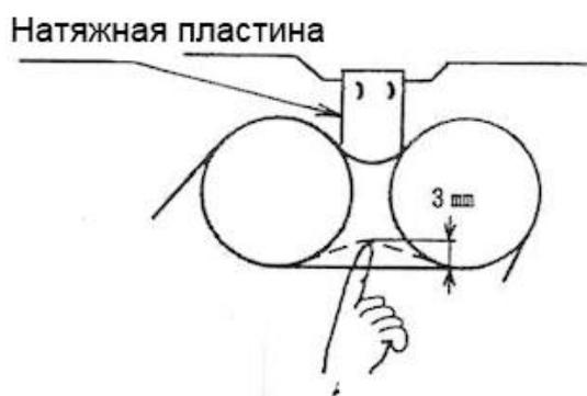
13.2.2 Регулировка натяжной пластины. Отрегулируйте натяжение цепи между рамой и крышкой с помощью натяжной пластины.
