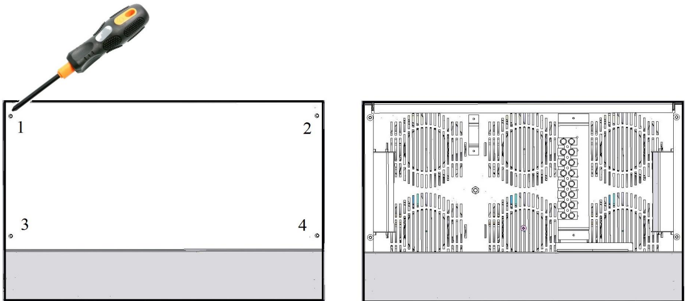
Рисунок 11. Схема зняття захисної кришки зверху корпусу стабілізатора
