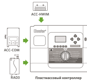
Коммуникационные компоненты ACC, установленного на стене
